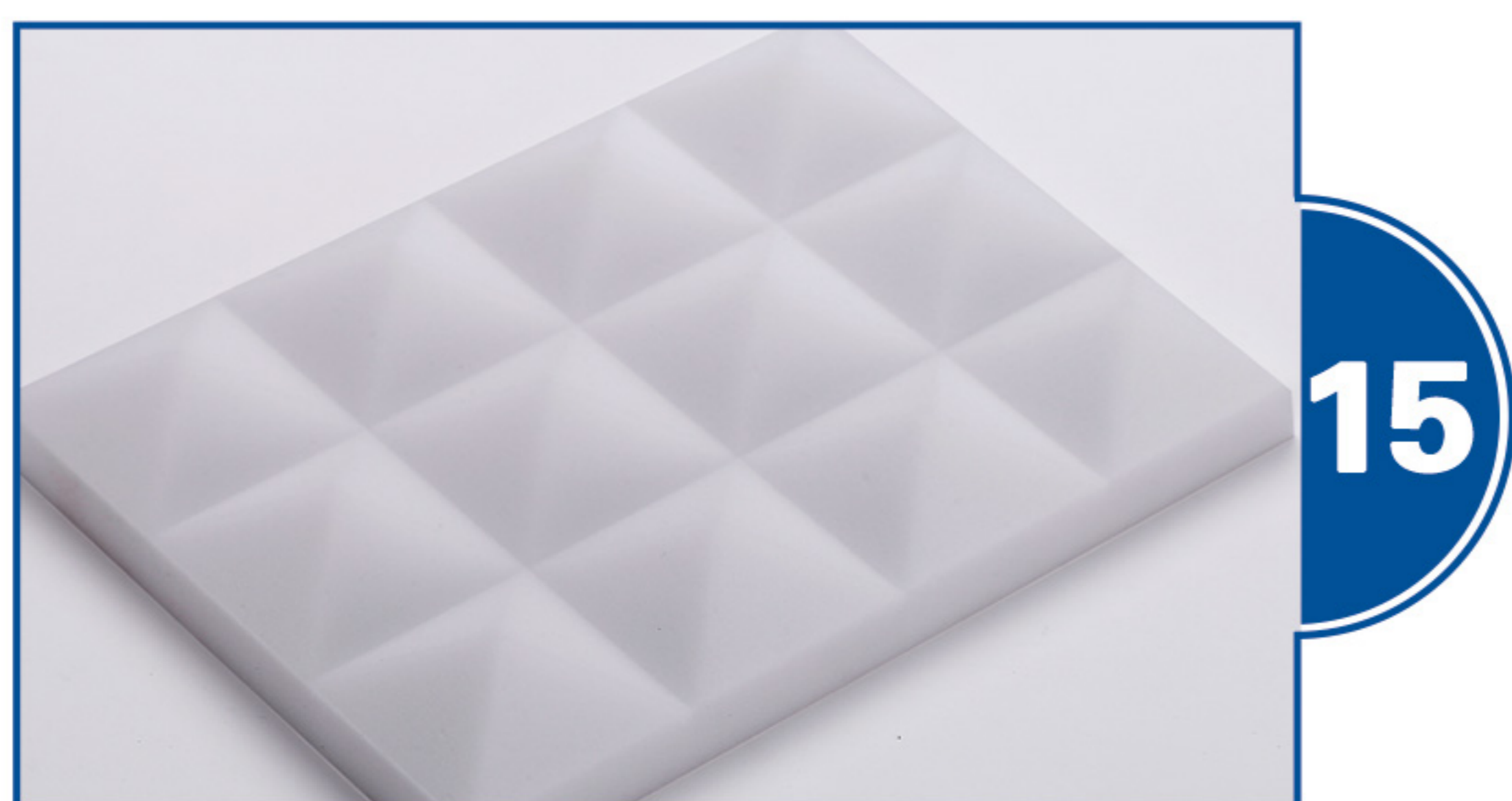
产品编号: FT-YX08050BJZT 产品特性: 满足GB8624-B1级阻燃、吸声系数NRC≥0.90 塔顶到塔底的高度和比例可调。 产品用途: 直播间、练歌房、录音棚的吸声应用, 会议室、演播厅、电影院等场所的混响时间调节, 设备的中高频降噪。
