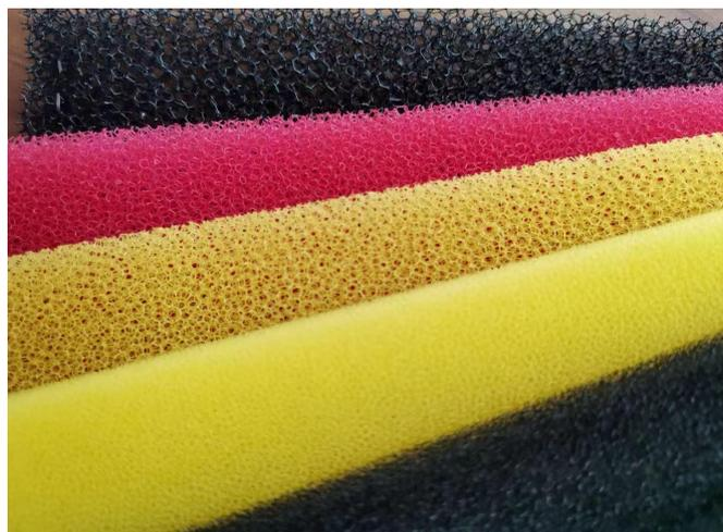
过滤网棉可根据不同的应用场景选择不同的孔径（ppi）来达到需要的效果。更有阻燃过滤网棉来应对高要求防火等级场景。
